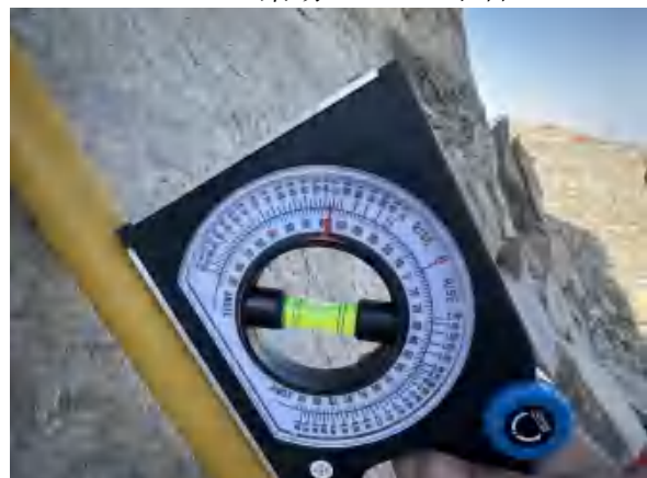
(d) +II 采场边坡坡度测量
