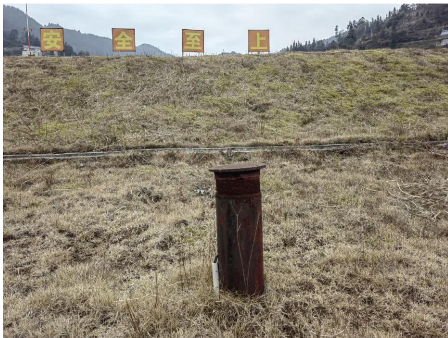
图 2.6-16 株梓洞尾矿库浸润线观测设施
